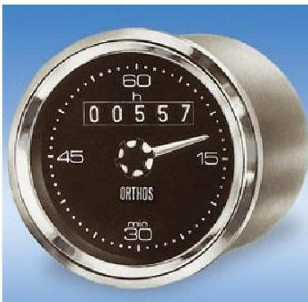
Système d'horlogerie entraîné par vibration. Montage horizontal. Sans aucun branchement. Précision +/- 3 % en fonctionnement continu. Etanche eau et poussière IP65. Température -15 +60°C. Capacité 99 999 heures et indication des minutes par l'aiguille. Sans remise à zéro possible.
